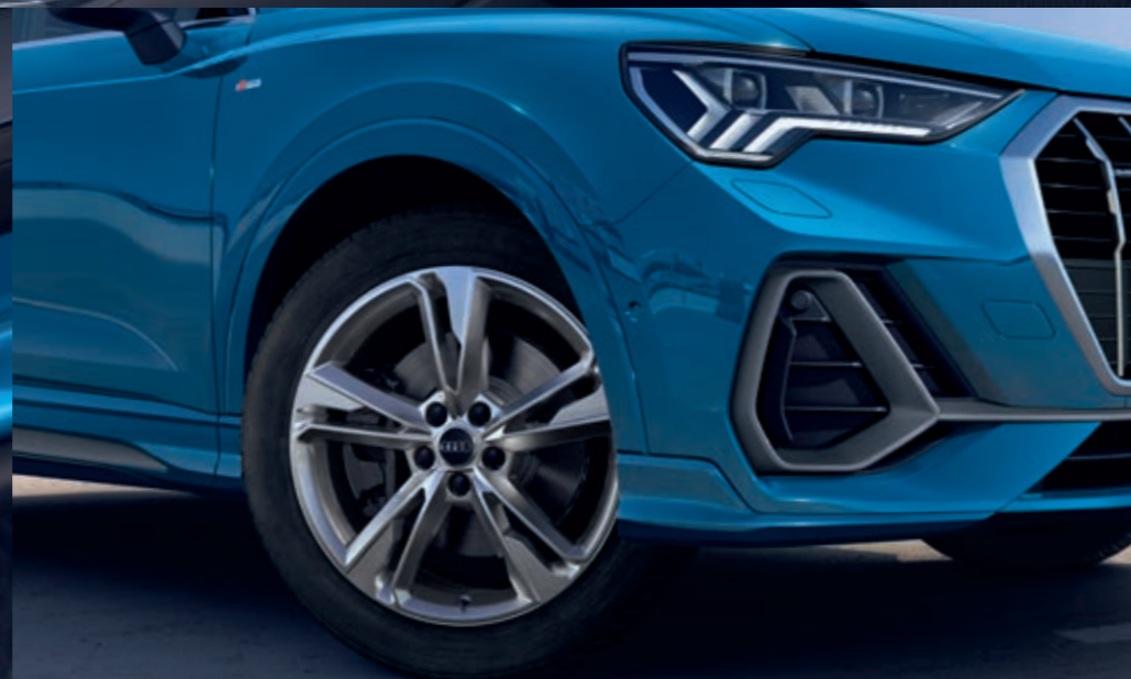
19-palčna aluminijasta lita platišča, 5-kraki dvojni dinamični design (S-design), velikost 7J x 19, pnevmatike 235/50 R 19 (opcija)
